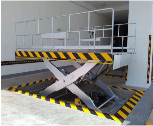
Εικόνα 9 Ψαλιδωτός ανυψωτήρας (Μοχλός, βίδα, οδοντωτή μπάρα)
