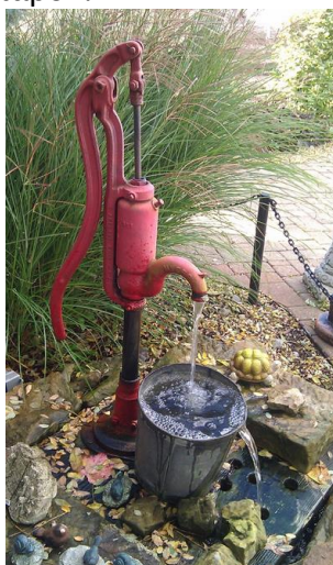
Εικόνα 6 Χειροκίνητη γεώτρηση (Μοχλός, άξονες)
