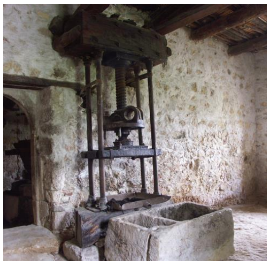
Εικόνα 7 Ελαιοπιεστήριο (Μοχλός, βίδα και άξονες)
